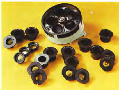
Bild 6. Der bildseitige Modulatorrevolver und die Modulatoren des Kontrasttubus zum JENAVAL
