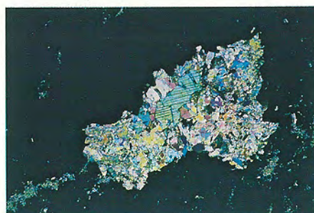
Anhydritkristall mit Polyhalitsaum, umgeben von Halit, Zechstein III, Flöz Ronnenberg, Polare 90°, M 4:1
